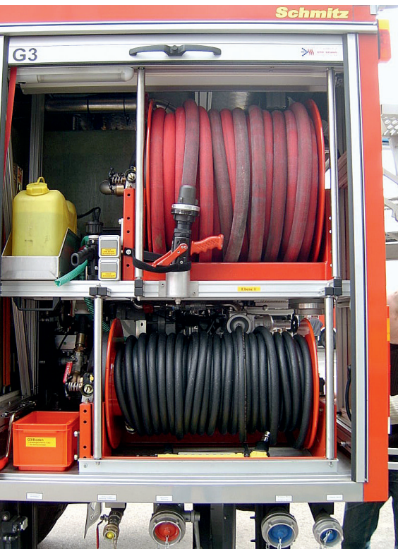
Bild 7 Fahrzeug mit drei formstabilen Schnellangriffseinrichtungen.
