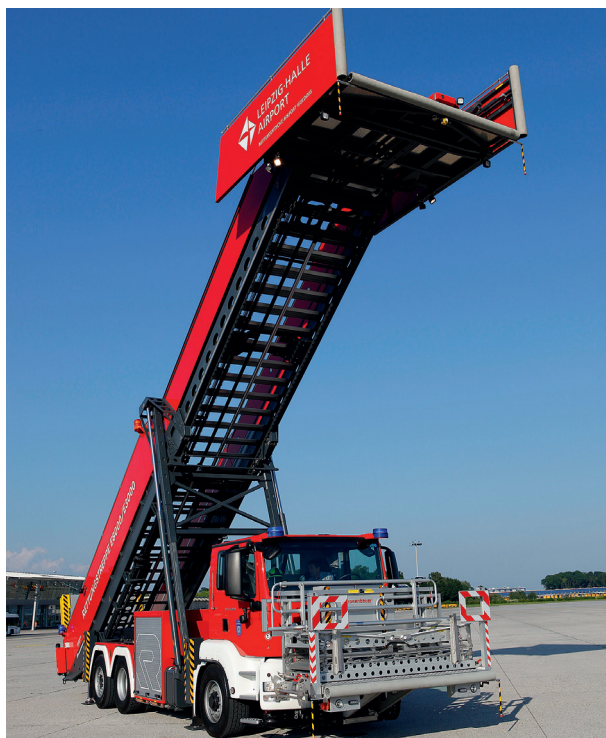
Bild 7 Die großzügig dimensionierte obere Rettungsplattform erleichtert das schnelle Verlassen des Flugzeuges.
